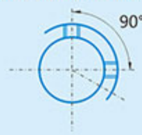
变更止动螺丝角度用KC90表示
