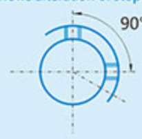
变更止动螺丝角度用KC90表示
