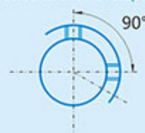
变更止动螺丝角度用KC90表示
